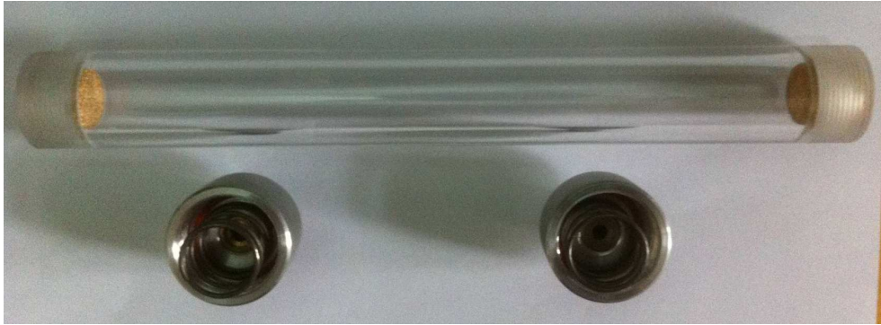
图 5-2 铜烧结过滤片安装图
