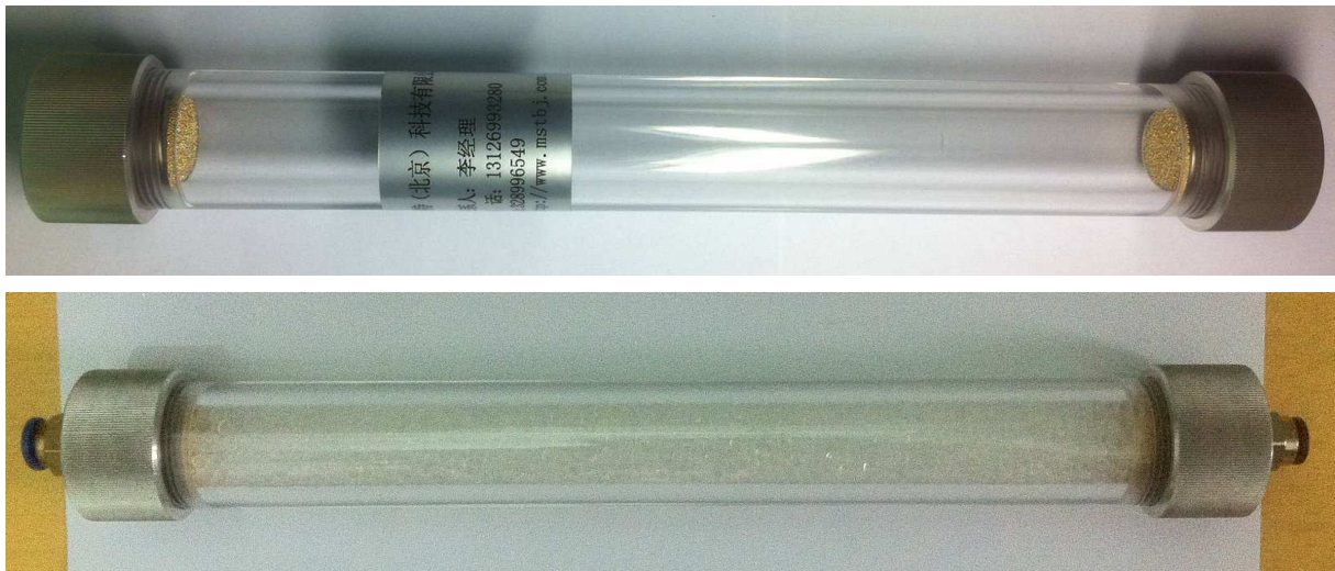
图 5-3 干燥管组装图
